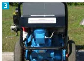
**3 Вариаторный мотор-редуктор** позволяет плавно менять производительность в полном диапазоне, моментально адаптируя установку к необходимому виду работ
